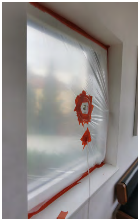
Bild 10.4 Die Druckverhältnisse am Fenster und auch zB. von Türen werden durch eine Abklebung mit einer Folie am besten bei offenem Fenster einfach sichtbar.
