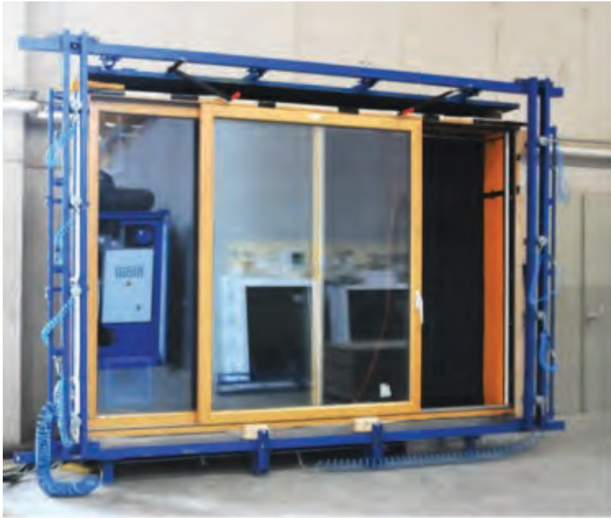
Bild 6.5 Prüfstand zur Messung der Luftdurchlässigkeit mit zur Prüfung vorbereiteter Schiebetüre
