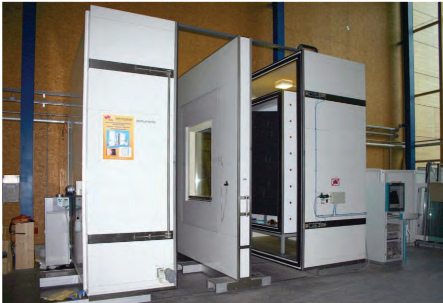
Bild 6.9 Geöffnete Hotbox am Labor für Bauphysik der TU Graz
